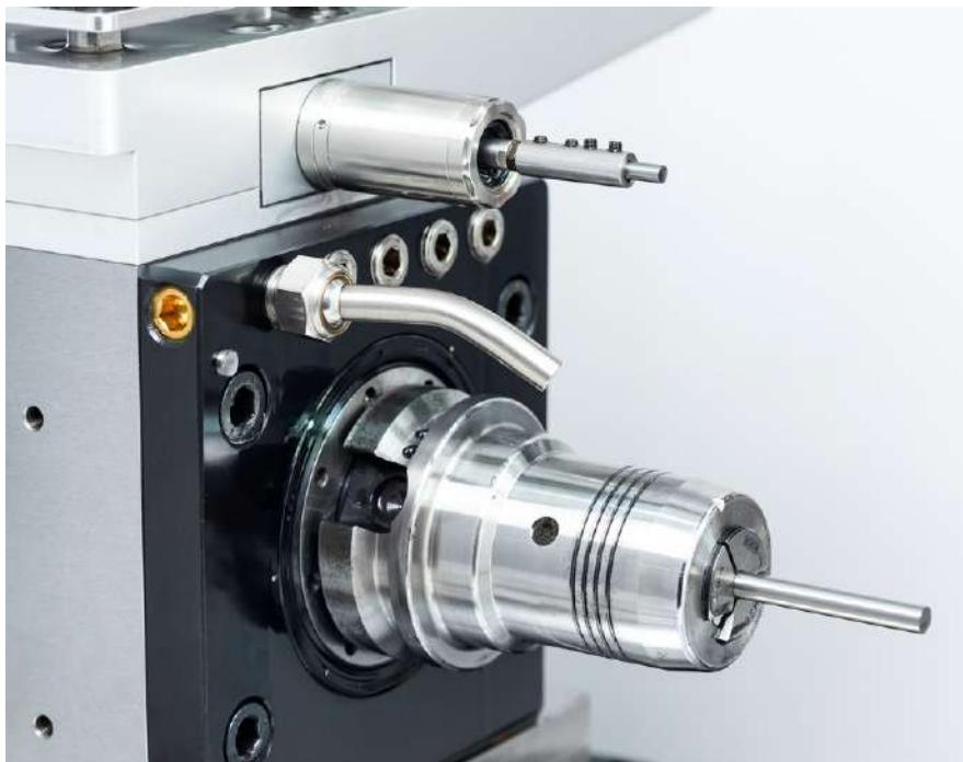
► Ось заготовки SK40 (ось А) оснащена моментным двигателем с разрешением 0,0001°, максимальная скорость которого составляет 1000 об/мин, что позволяет выполнять цилиндрическое шлифование.
