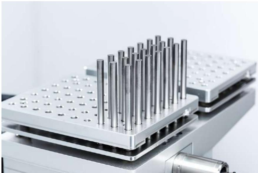
► Легко заменяемое, универсальное использование заготовок разных размеров, не требующее повторного позиционирования робота. Вместимость до 70 шт. на лоток, используется метод производства средними партиями для предотвращения влияния на точность инструмента из-за осаждения вольфрамового порошка.
