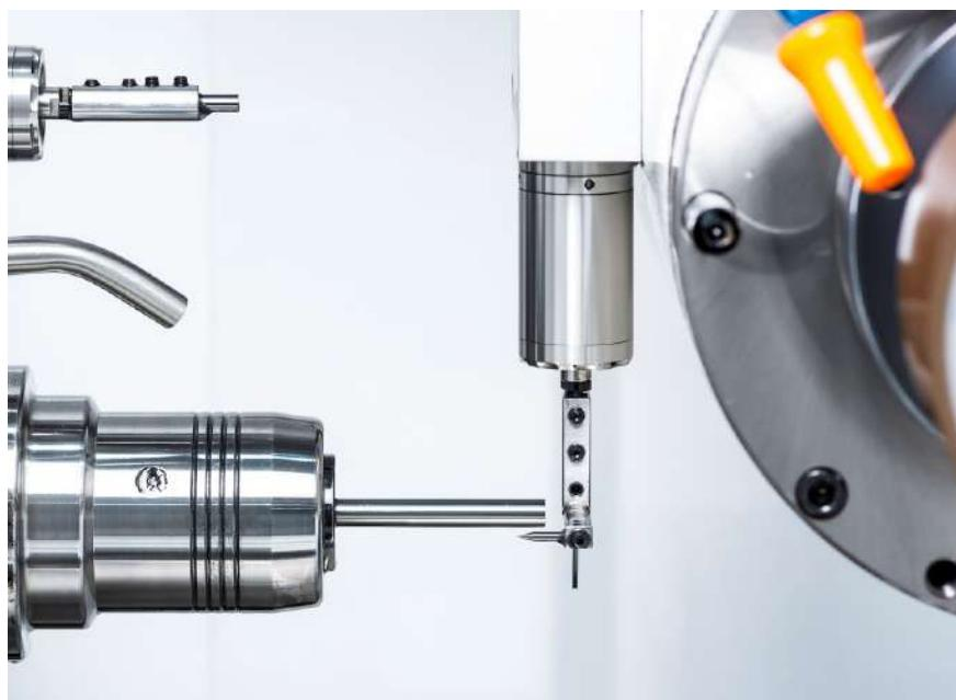
► Быстрое позиционирование заготовки в режиме онлайн, измерение и регулировка параметров заготовки во время обработки обеспечивают качество обрабатываемого инструмента.
